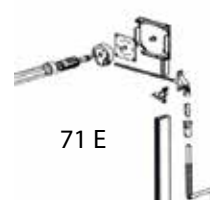
Aționare reductor cu manivelă pliabilă
